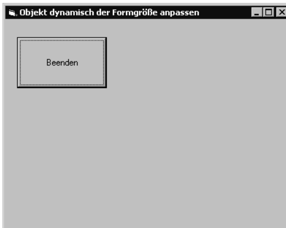
Abbildung 6.45: Bei Veränderung der Formulargröße ändert sich auch die Größe der Befehlsschaltfläche
